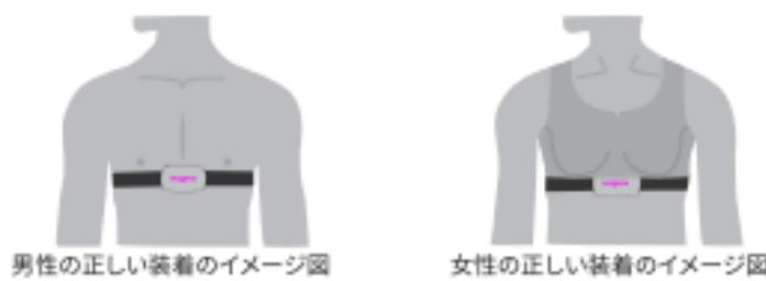
5. 正しく装着するとセンサーは電源が自動的に入り、前面のLEDが点滅(10回で消灯)し、サイコン、スポーツウォッチ、アプリで正しいANT idまたはBluetooth名を選択すると心拍数データが発送されます。
